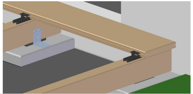
Bild 8. Je Unterkonstruktion 1 H-Stick verwenden.
