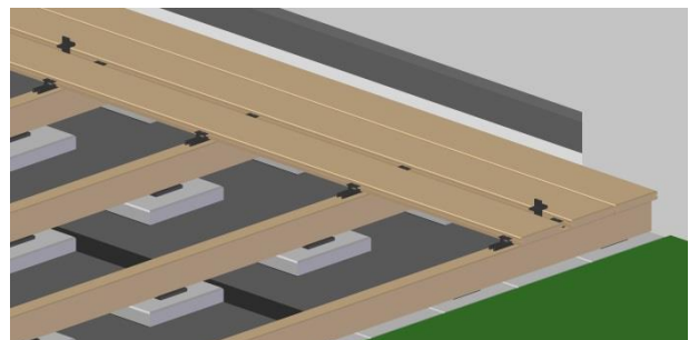
Bild 12. Alle weiteren Dielen werden genauso verschraubt.
