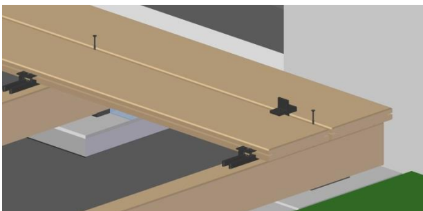
Bild 11. Beiliegende Schrauben einsetzen und festschrauben
