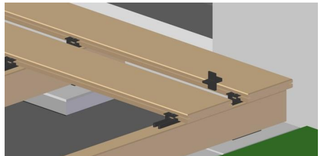
Bild 10. 2 Diele bis an den Abstandshalter schieben.
